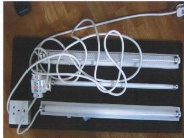
不同類型光管的耗電量比較實驗配置(讓幼稚園學生作探究式學習)
